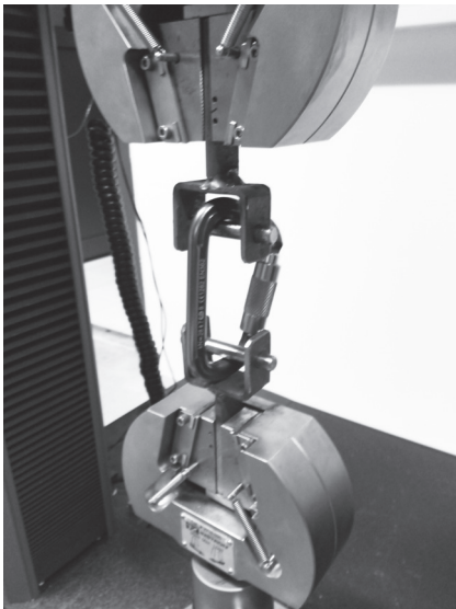
Joonis 3. Katse läbiviimine Instron 5969 tõmbeteimiga (autori foto)
